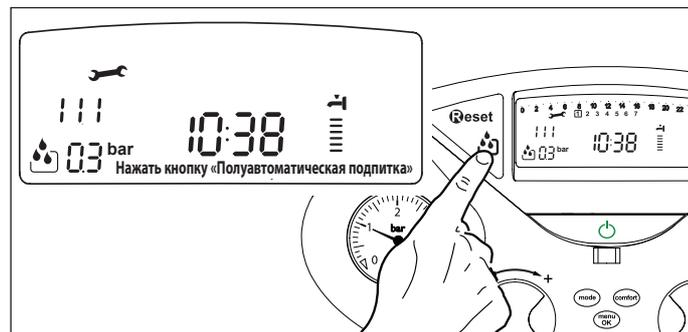
Котел следует перезапустить, а контур отопления подпитать, нажав кнопку "Полуавтоматическая подпитка".
