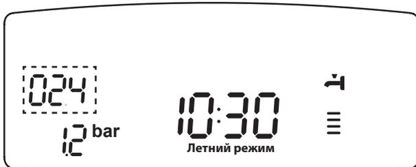
Три режима функционирования отображаются с помощью трех индикаторов (см. рисунок).
